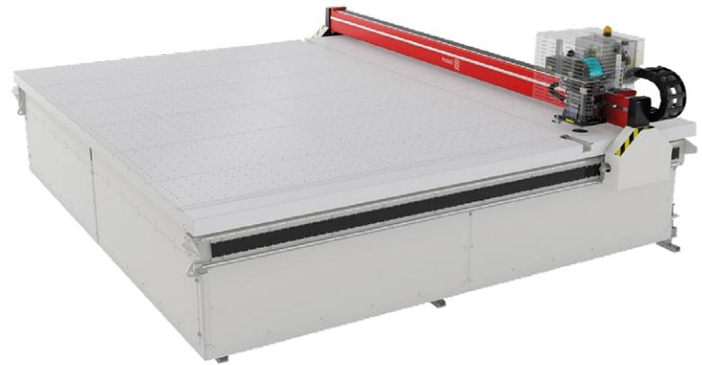
Dies wird durch den vollständigen Abtrag des Beschichtungsmaterials durch Laserstrahlung erreicht und ohne das Glas zu beschädigen.
